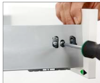
3. Регулиране на челото L/R ( \pm 1,5 мм)
